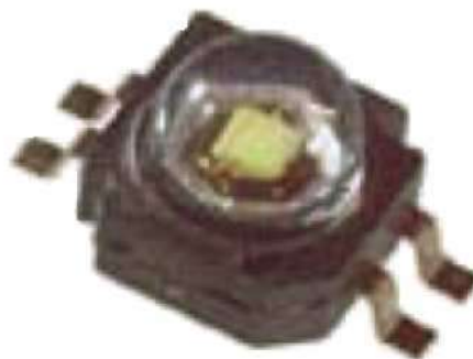
Рис. 8.Д – Світлодіод білого світла (40лм/Вт)
