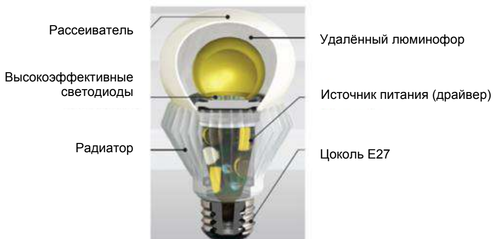
Рис. 65. Светодиодные лампы, в которых используется технология удалённого люминофора для получения белого света, производства компаний Philips (а), Cree (б), Lighting Science Group и Light Prescriptions Innovators (в).
