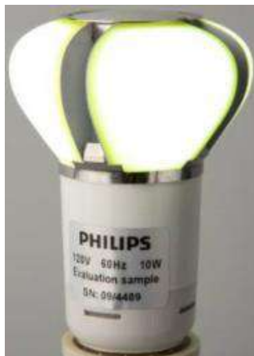
Рис. 128. Светодиодная лампа для замены традиционной лампы накаливания мощностью 60 Вт производства компании Philips (910 лм, 9.7 Вт, 93.4 лм/Вт, CRI = 93), удостоенная премии Департамента энергетики США в августе 2011 г.
