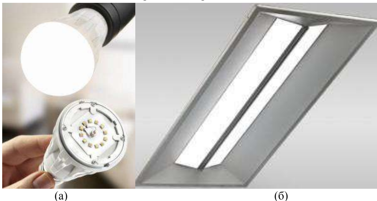
Рис. 91. Светодиодная лампа производства компании OSRAM, цвет излучения которой построен на использовании белых и красных светодиодов (а). Светильник CR14, CR22, CR24 производства компании Cree, излучение в котором организовано по той же концепции (б).
