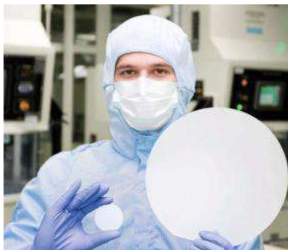
Рис. 49. Двухдюймовая и десяти дюймовая подложка сапфира (LEDs Magazine, February 2011).
