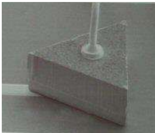
Рис. 8. Светодиодный чип GaN, выращенный на подложке GaN. Форма продольного сечения чипа представляет собой треугольник.
