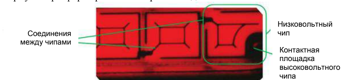
Рис. 10. Структурные элементы высоковольтного светодиодного чипа [13].
