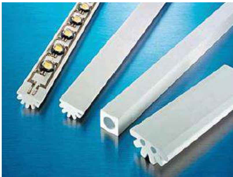
Рис. 107. Монтаж светодиодов непосредственно на материал радиатора CeramCool.
