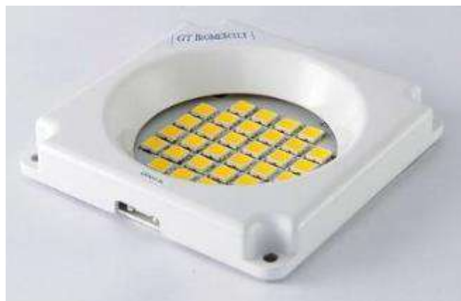
Рис. 148. Светодиодный модуль AirglowOne, работающий на переменном токе без использования драйвера.
