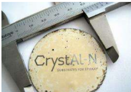
Рис. 50. 2" подложка AlN от Crystal-N ( Compound Semiconductor , June 2013).
