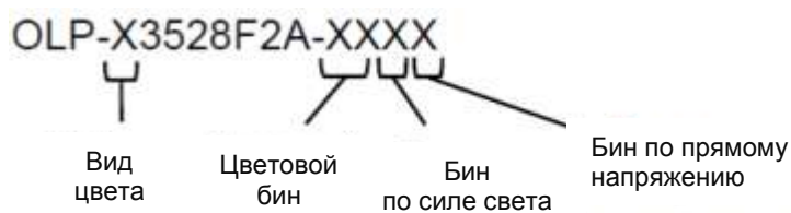
Рис. 31. Один из вариантов маркировки светодиода: первые буквы чаще всего уникальны и обозначают компанию-производителя, последующие символы — код продукта и его характеристик.
