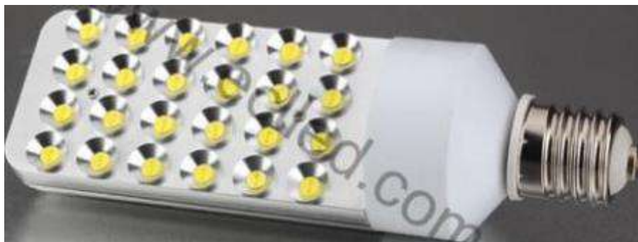
Рис. 81. Светодиодная лампа мощностью 20 и 24 Вт, предназначенная для замены традиционных ламп соответственно мощностью 150 и 200 Вт, применяемых в уличных фонарях. Металлический отражатель выполнен над каждым отдельным светодиодом.
