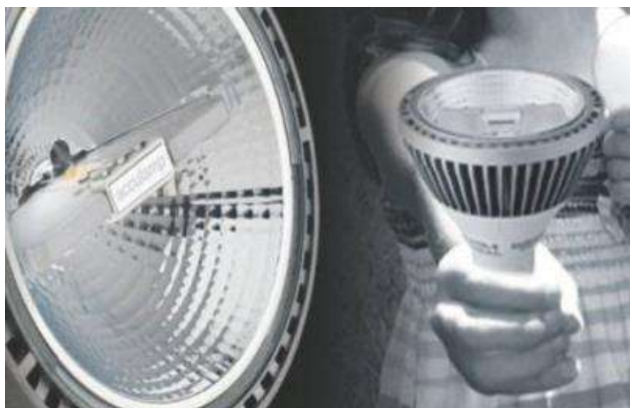
Рис. 82. Светодиодные лампы Acculamp производства компании AcuityBrands, Inc с вертикально установленными светодиодами; в этих лампах отсутствуют вторичные линзы.
