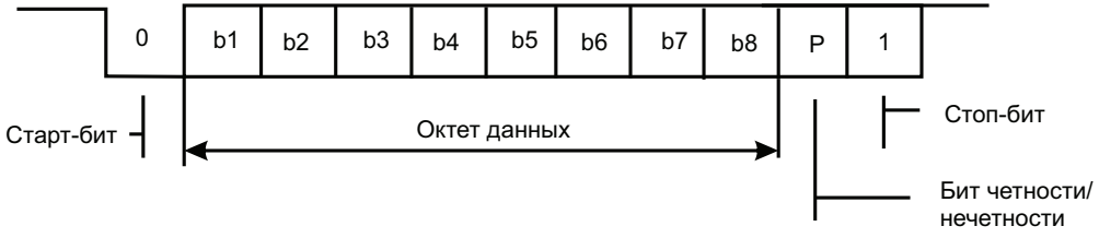
Рис. 4. Схема передачи UART-символа
