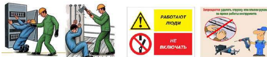
Рис.3.7 Нарушения правил электробезопасности
