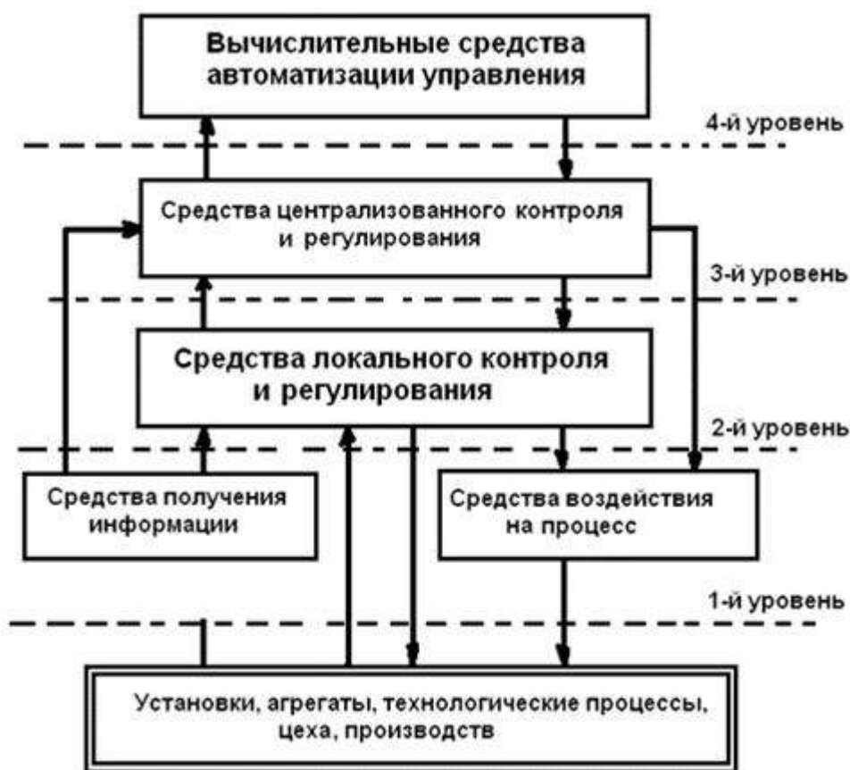
Рис. 1. Иерархическая структура технических средств ГСП
