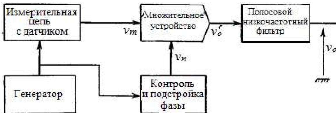
Рис. 63. Блок-схема синхронного детектора
