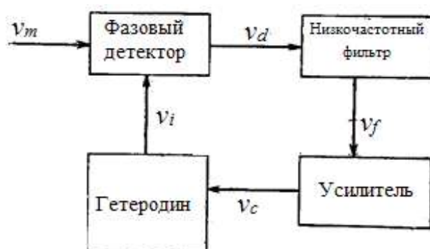
Рис. 65. Блок-схема частотного детектора
