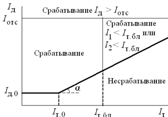
Рис. 2.6. Характеристика срабатывания ДЗТ АТ ( I_d — дифференциальный ток; I_T — ток торможения)
