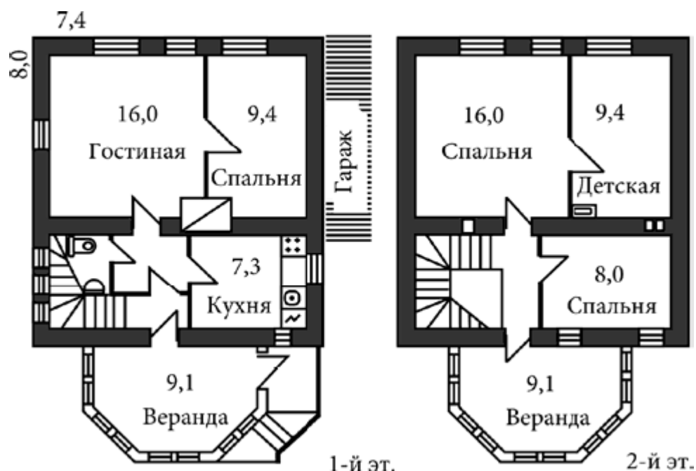
Рис. 2.1. Планировка дома с зимним отоплением только первого этажа (вариант 1)
