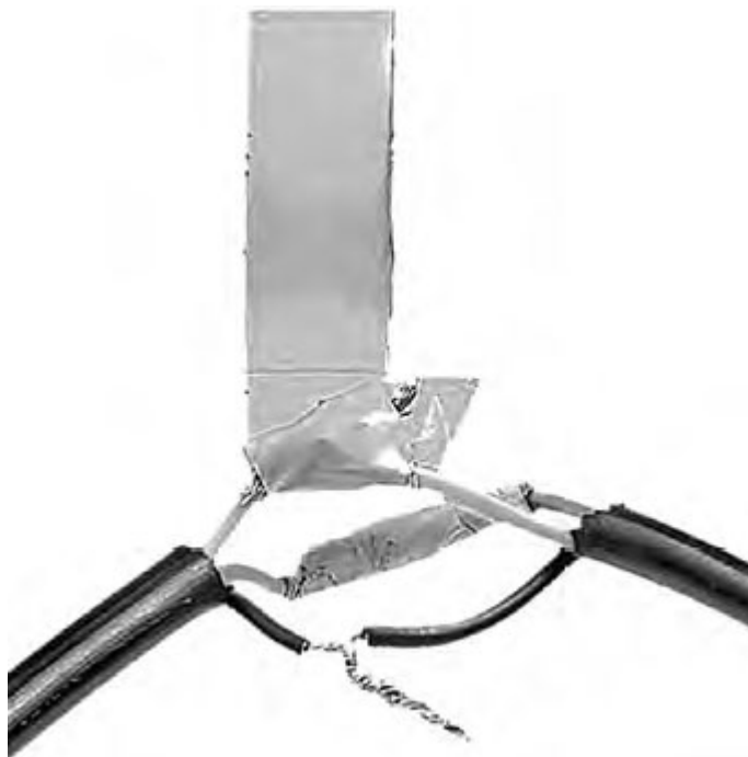
Рис. 4.5. Простейшая ручная скрутка ТПЖ
