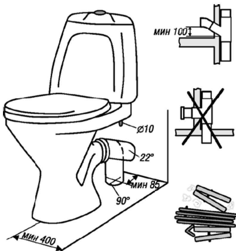
Рис. 5.6. Базовые размеры для установки унитаза
