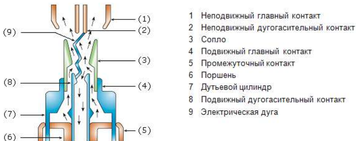
Рисунок 8.9- Принцип дугогашения
