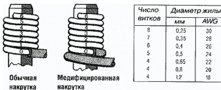
Рис. 3.6. Монтаж накруткой.
