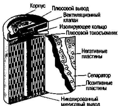
Рис. 2.2. Устройство никель-кадмиевого аккумулятора
