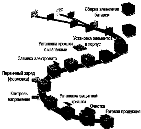
Рис. 3.4. Цикл производства автомобильных свинцово-кислотных батарей (пример)
