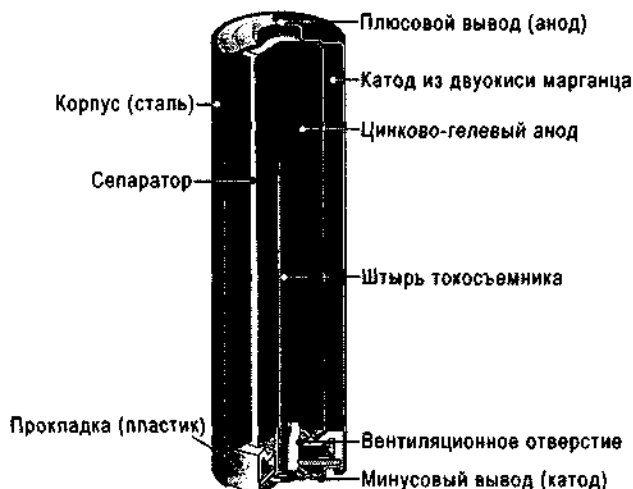
Рис. 5.1. Устройство алкалинового элемента
