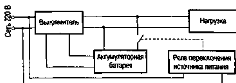
Рис. 3.10. Структурная схема источника бесперебойного питания
