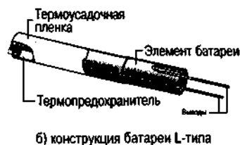
Рис. 2.8. Конструкция аккумуляторных батарей L- и F-типов
