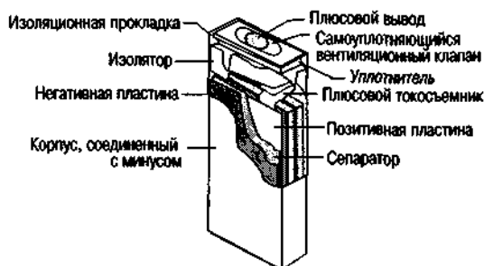
Рис. 2.5. Конструкция призматического аккумулятора
