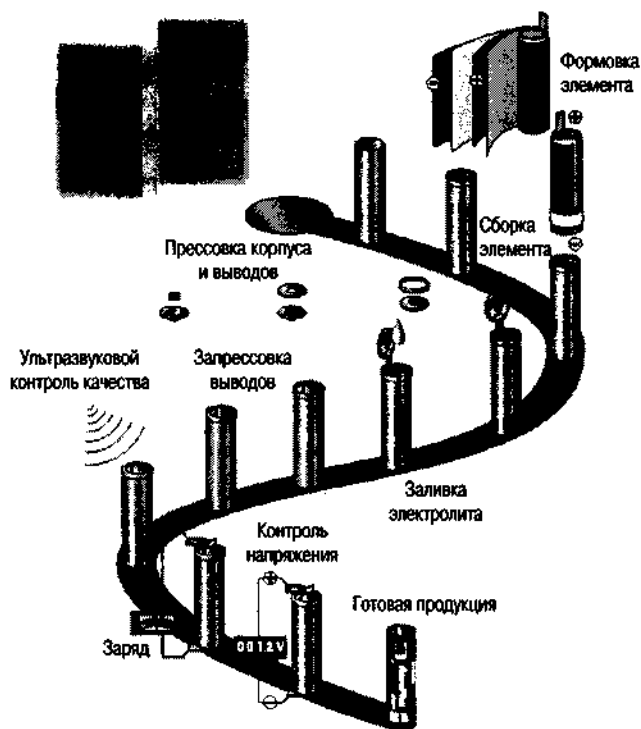
Рис. 2.4. Процесс производства никель-металлгидридных аккумуляторов
