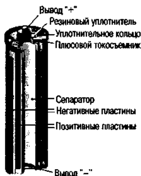
Рис. 2.3. Устройство никель-металлгидридного аккумулятора
