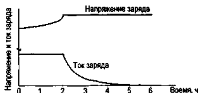
Рис. 3.7. Характеристики заряда при постоянных значениях напряжения и тока заряда
