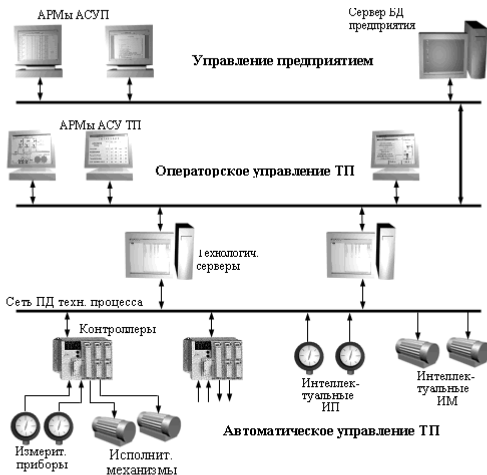
Рис. 1.2. Функциональная схема современного производства
