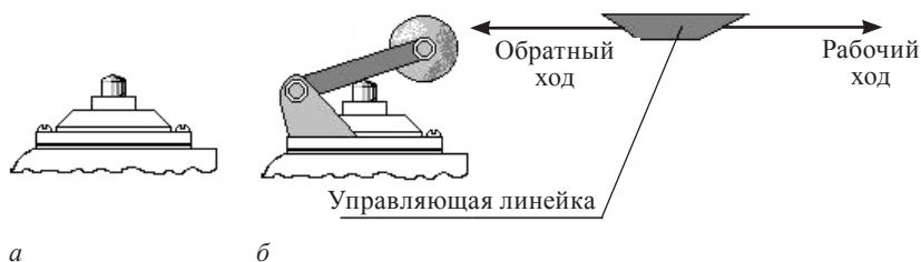
Рис. 2.21. Рабочие головки и рычаги дискретных контактных датчиков перемещения: а — плунжерная; б — неселективная роликовая
