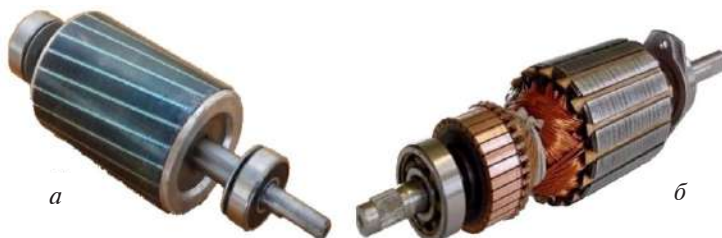
Рис. 2. Устройство ротора асинхронного двигателя с обмоткой: а – короткозамкнутой; б – фазной
