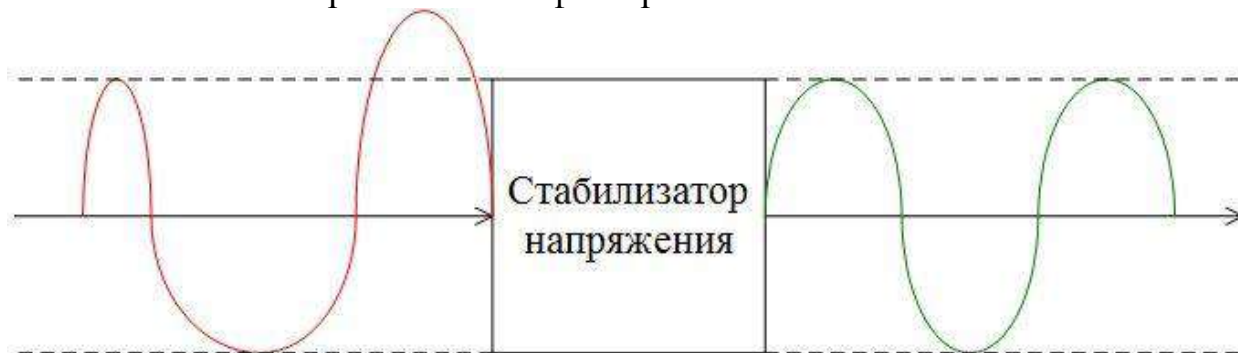
Рисунок 1.34 — Характеристика работы стабилизатора
