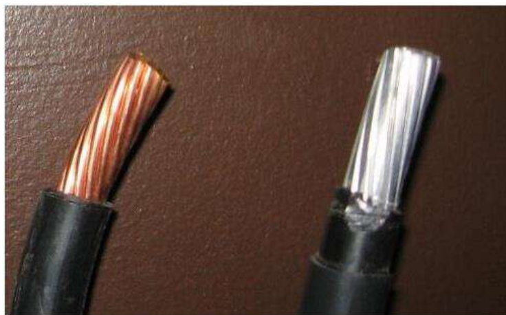
Рисунок 6.1 – Сравнение алюминия и меди
