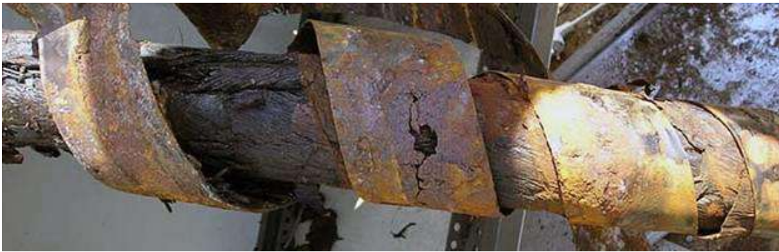
Рисунок 6.11 – коррозия металлических элементов кабеля
