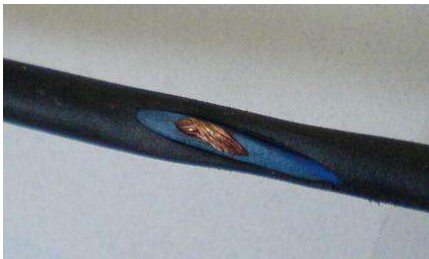
Рисунок 6.10 – Механическое повреждение кабеля
