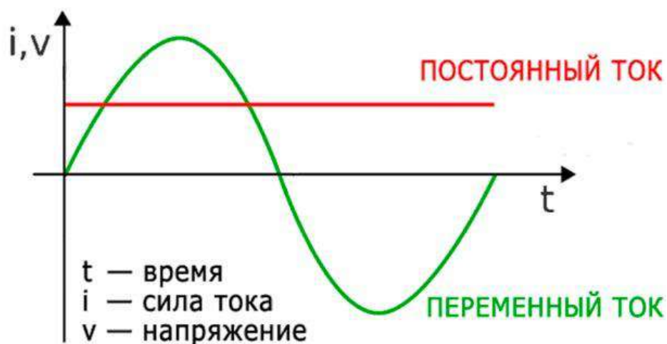
Рисунок 1.37 – Временная характеристика постоянного и переменного тока
