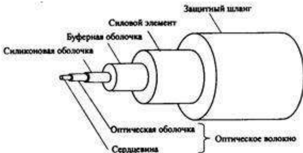
Рисунок 4.3 – . Конструкция волоконно-оптического кабеля
