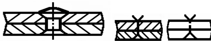
Рисунок 3.26 – Зображення заклепок у розрізі і їхнє умовне позначення
