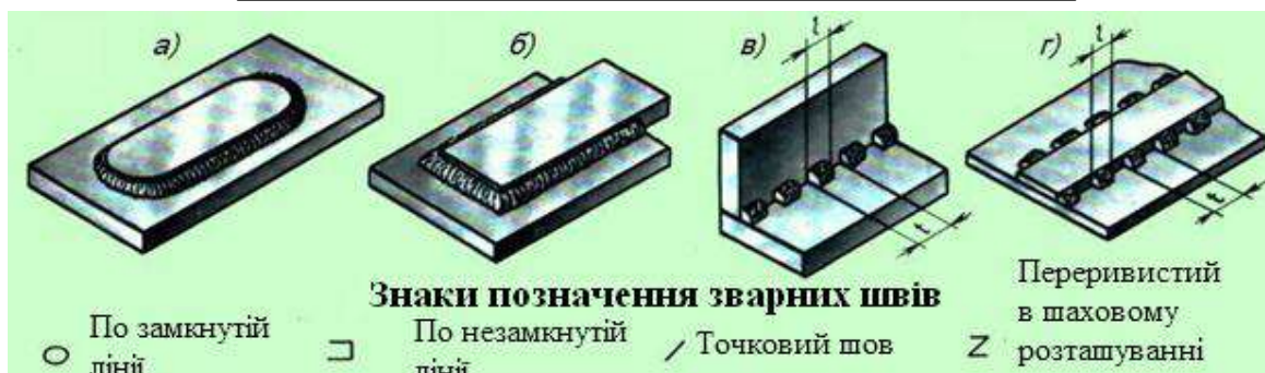
Рисунок 3.18 – Допоміжні знаки позначення зварних швів
