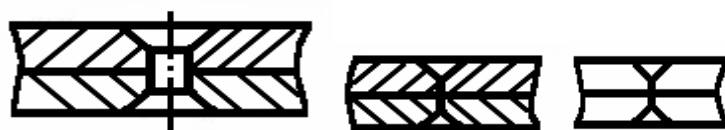
Рисунок 3.25 – Зображення заклепок у розрізі і їхнє умовне позначення
