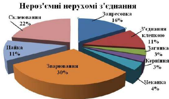
Рисунок 3.16 – Види нероз'ємних з'єднань
