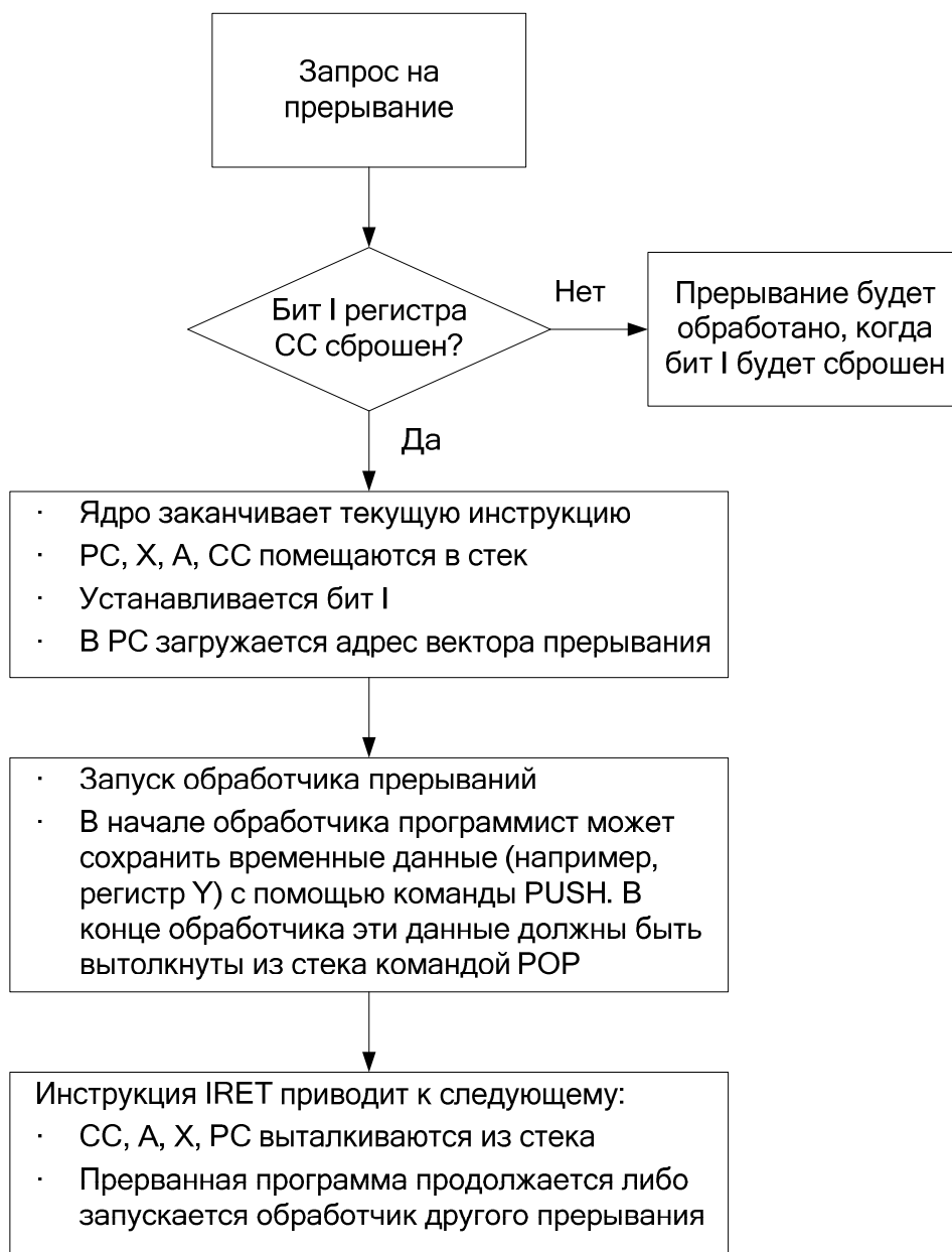
Рис. 1.23. Механизм обработки прерываний семейства ST7
