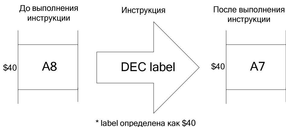
Рис. 1.12. Пример прямой адресации
