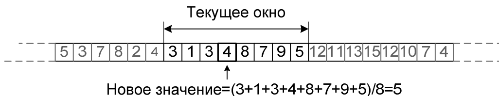
Рис. 4.25. Пример 8-элементного усредняющего оконного фильтра
