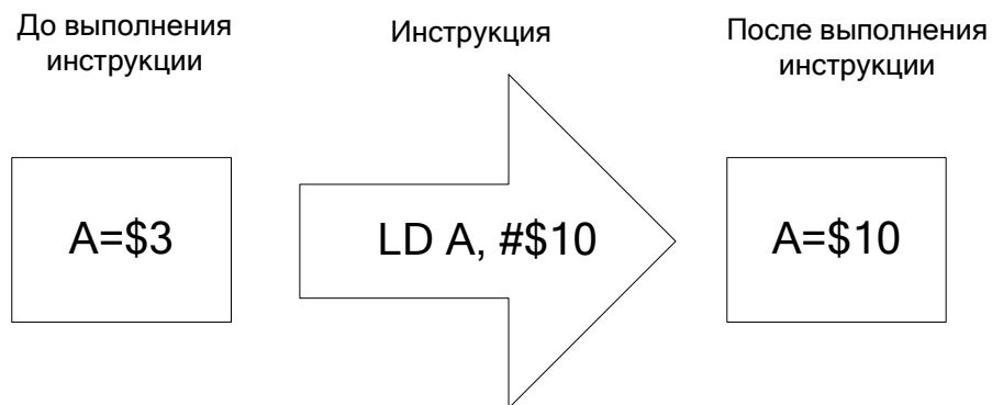
Рис. 1.11. Пример непосредственной адресации
