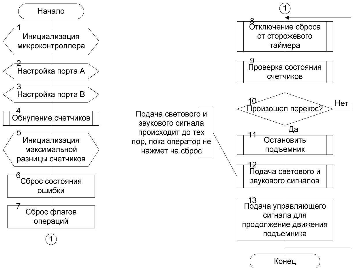
Рис. 3.10. Блок схема основной подпрограммы
