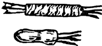
Рис. 3.27. Изолировка места опрессовки
