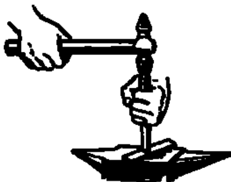
Рис. 10.8. Рубка полосового металла
