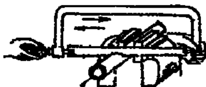
Рис. 7.22. Разрезание трубы
