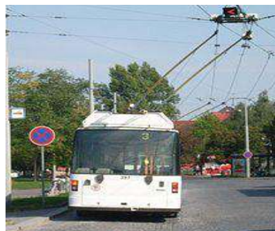
Рисунок 10 – Троллейбусная стрелка с указателем направления
