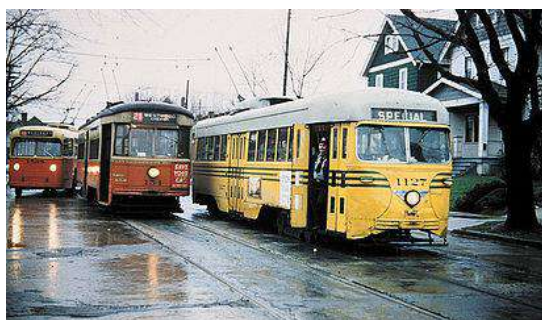
Рисунок 11 – Трамваи и троллейбус в Цинциннати за неделю до закрытия трамвайной линии. Используется общая контактная сеть
