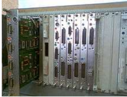
Рис. 2. Корзина з контролерами й платами обв'язки системи ЧПК Siemens Sinumerik (висунуто плату енкодерів)
