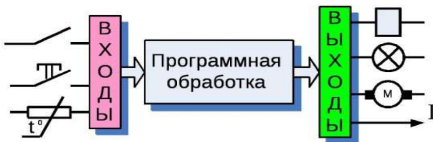
Рис.5.41. Принцип работы ПЛК
