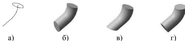
Рисунок 5.4 - Кинематический элемент: а) эскиз сечения и траектория; б) перемещение сечения с сохранением угла наклона; в) перемещение сечения параллельно самому себе; г) перемещение сечения ортогонально траектории
