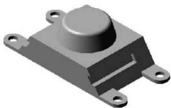
Рисунок 1.7 - Бобышка и лапки приклеены к основанию тела, пазы и отверстия – вырезаны
