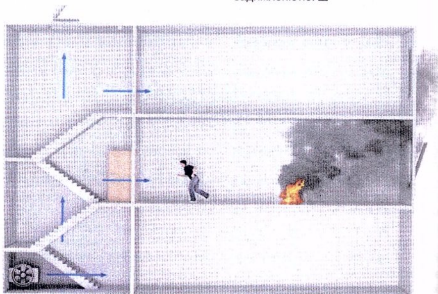
Рисунок 9 – Витіснення димових газів (наприклад, за допомогою систем зі створення різниці тисків)
