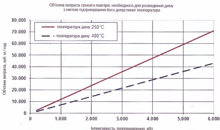
Рисунок 5 – Об'ємна витрата, необхідна для обмеження температур диму
