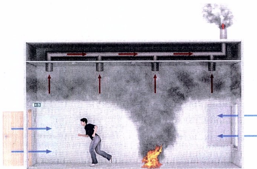
Рисунок 8 – Утворення шару димових газів (наприклад, у випадку механічної системи димовидалення)
