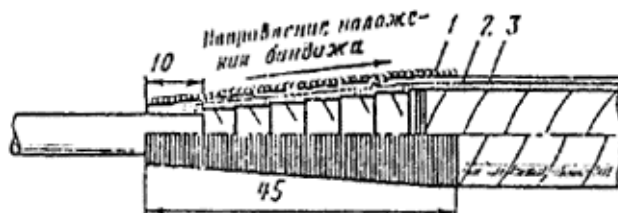
Рис. 55. Герметизация однопроволочной жилы.
