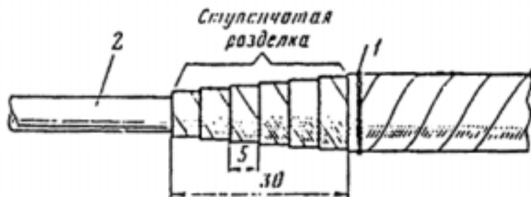
Рис. 54. Снятие изоляции с конца однопроволочной жилы.
