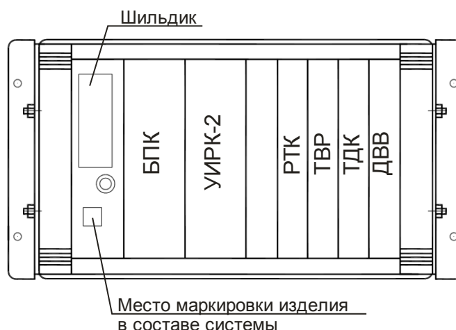
Рис. 1 задняя панель К-2000 базовой модификации.
