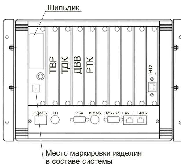
Рис. 2 задняя панель К-2000 модификации расширения.
