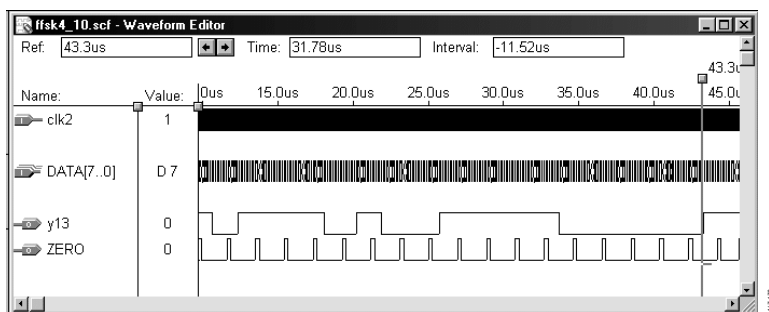
Рис. 7.10. Результаты моделирования в системе MAX+PLUS II
