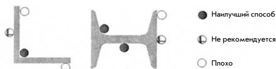
Рис. 23. Прокладка кабелей по металлическим конструкциям здания
