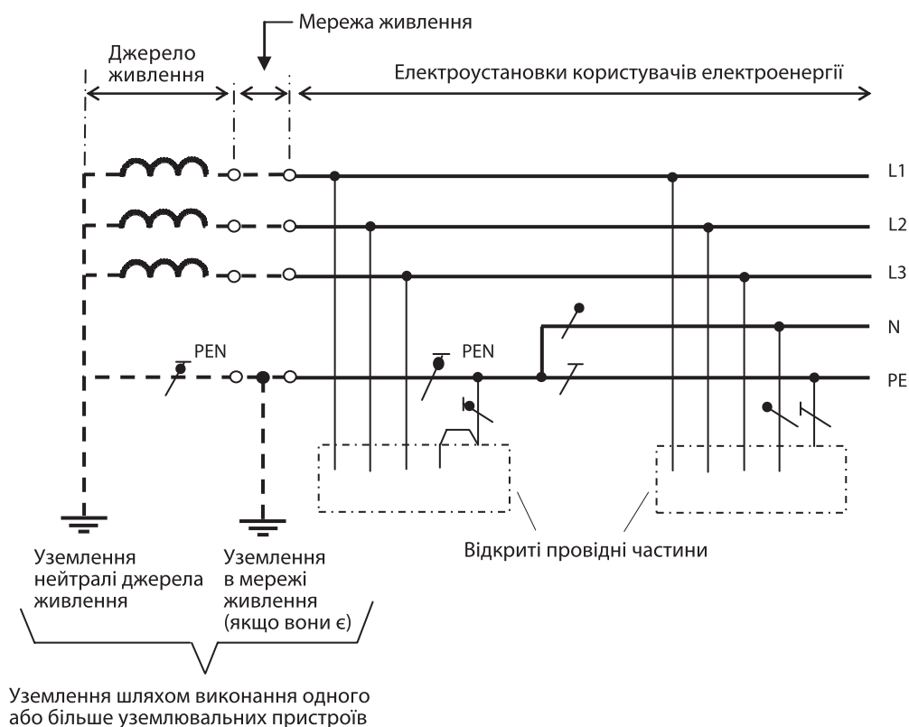
Рисунок Д.3 — Система TN-S з уземленою нейтральною точкою і нерозподіленим нейтральним провідником
