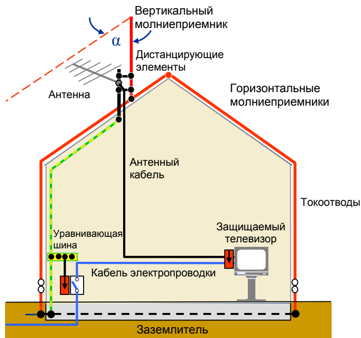
Рис. 4. Защита мачты и антенны от прямого удара молнии [11]
