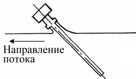
Рис.4. Установка ТУДЭ М1 на трубопроводе большого диаметра
