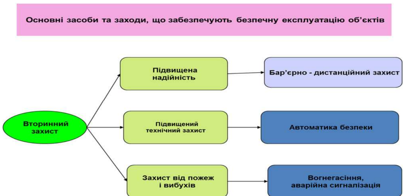
Рисунок 3.5 – Треступінчаста схема забезпечення безпечного стану об'єктів: (вторинний захист)
