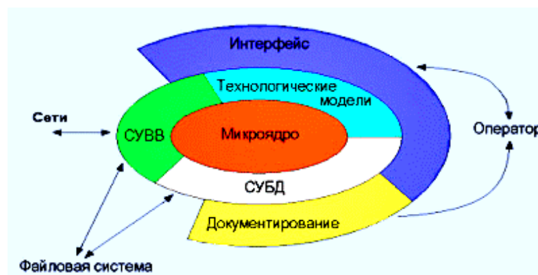
Рис.4.3. Структура системы реального времени ТкА
