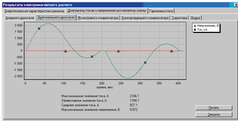
Рис. 6.8. Диаграмма тока и напряжения диагонального дросселя
