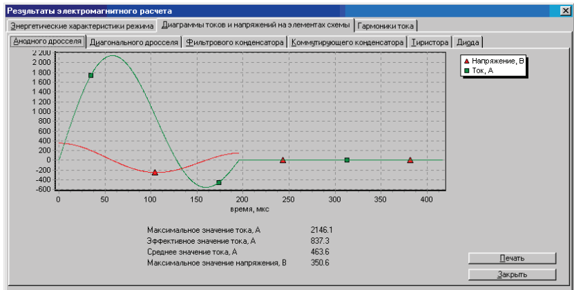
Рис. 6.7. Диаграмма тока и напряжения анодного дросселя
