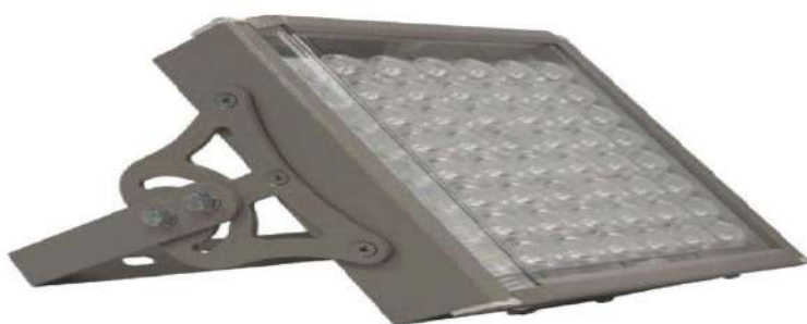
Рисунок 1.9 – Светодиодный светильник для наружного освещения LeaderLight LL-ДБУ-064-0205-65Д (потребляемая мощность 64 Вт, световой поток 4300, R_a > 75\% , КСС типа Д, ресурс работы 50000 ч.)
