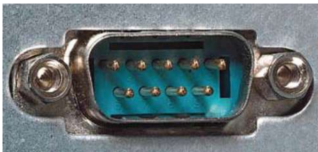
Рис. 10. 9-контактный последовательный кабель RS-232
