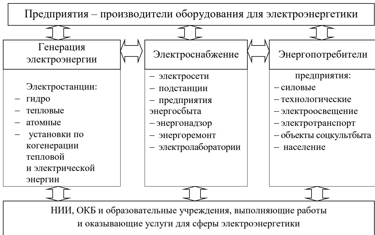
Рис. 1.1. Структурирование электроэнергетики как большой системы
