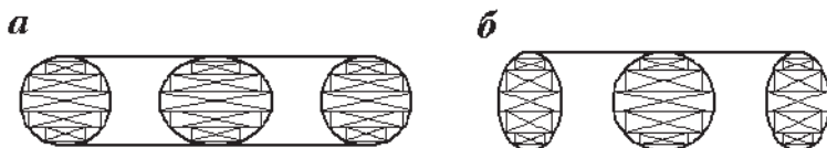
Рис. 3.13. Возможные конструкции магнитопровода Зоннса:
