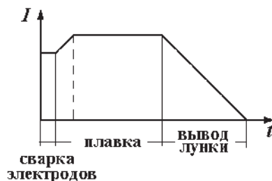
Рис. 2.20. Зависимость тока ВДП от стадии технологического процесса
