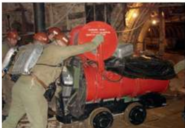
Рис. 4. Применение пеногенераторной установки
