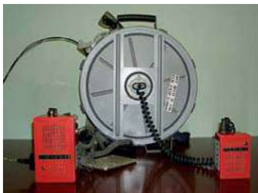
Рис. 10. Аппарат связи (аппарат базы и отделения) с катушкой связи КСГ
