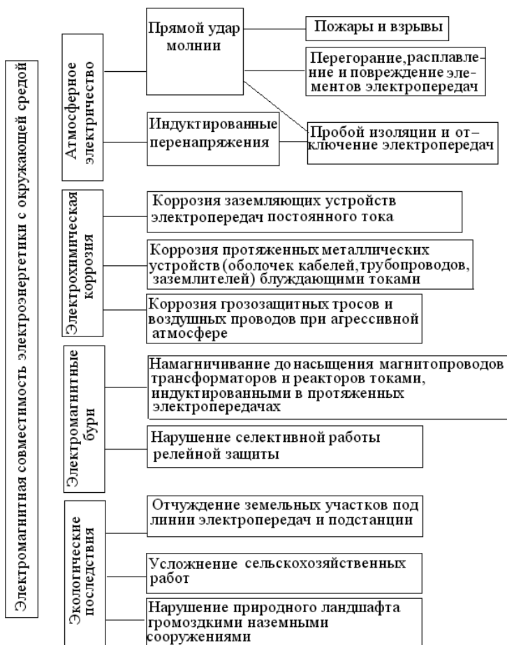
Рис. 11.2. ЭМС электроэнергетики с окружающей средой (ЭКО–ЭМС)
