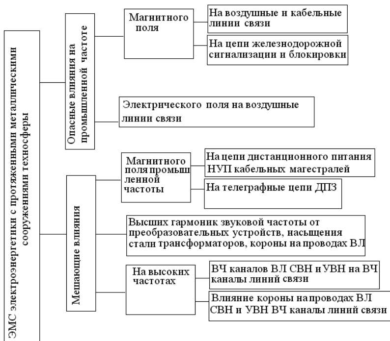
Рис. 11.4. ЭМС электроэнергетики с протяженными металлическими сооружениями (ТЕХНО–ЭМС)
