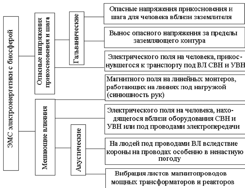
Рис. 11.3. Электромагнитная совместимость электроэнергетики с биосферой
