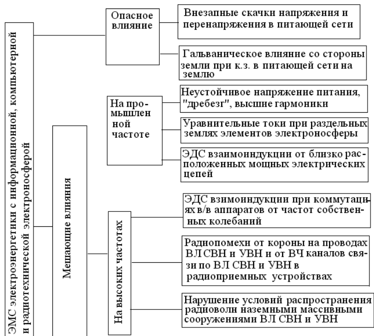
Рис. 11.5. ЭМС электроэнергетики с информационной, компьютерной и радиотехнической электроносферой (ЭЛЕКТРОННО–ЭМС)
