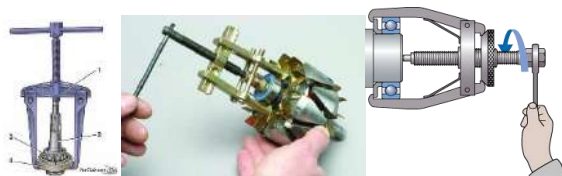
Рис. 1 - Пример выполнения демонтажа подшипника качения с помощью универсального съемника: 1 – съёмник; 2- вал; 3 – роликовый конический подшипник; 4 - оправка
