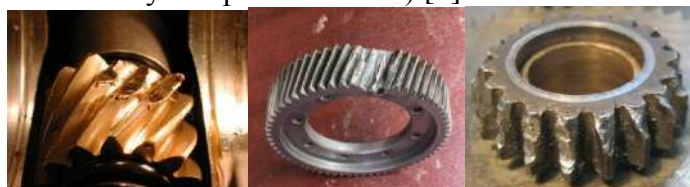
Рис.6. Износ и поломка зубьев шестерни
