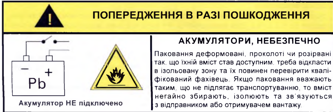
Рисунок DD.1 — Попереджувальна етикетка для виробів, що транспортують з відключеним акумулятором
