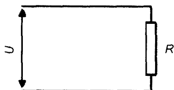
Рисунок ВВ.1 — Еталонна резистивна навантага
