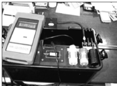
Рис. 4.63. Газоанализатор «Qvintox» с блоком управления и детектирования
