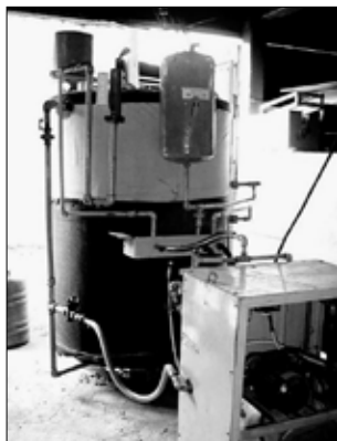
Рис. 4.60. Общий вид БГУ-1,5 УрФУ (На переднем плане – блок вспомогательных устройств с системой управления)
