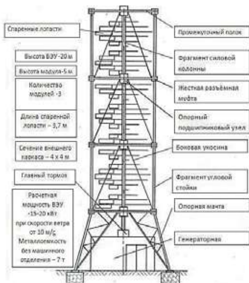
Рис. 4.7. Схема конструкции роторно-лепестковой ВЭУ «Кардэя»
