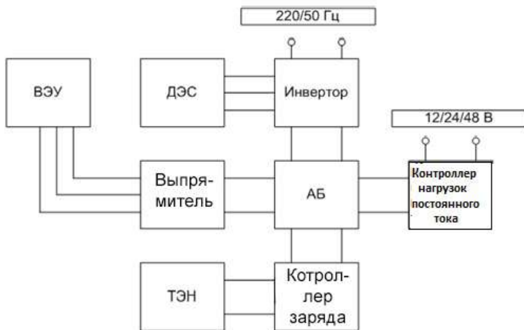
Рис. 4.1. Структурная схема ветродизельной установки
