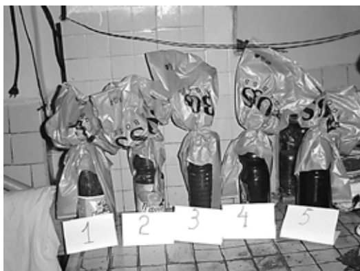
Рис. 4.74. Иллюстрация опыта по скорости метангенерации в зависимости от влажности субстрата (Контейнер № 1 – влажность 80 %; № 2 – 85 %; № 3 – 88 %; № 4 – 90 %; № 5 – 92 %)
