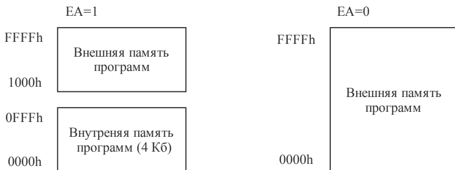
Рис. 4. Организация памяти программ в пространстве CSEG
