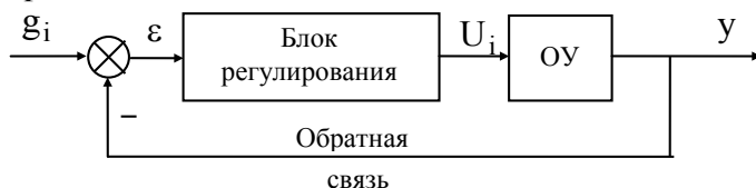
Рис. 2.6. Структурная схема элементарной САР
