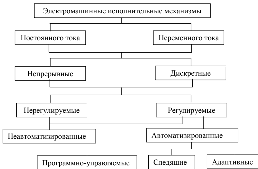
Рис. 17.3. Классификация электромашинных ИМ
