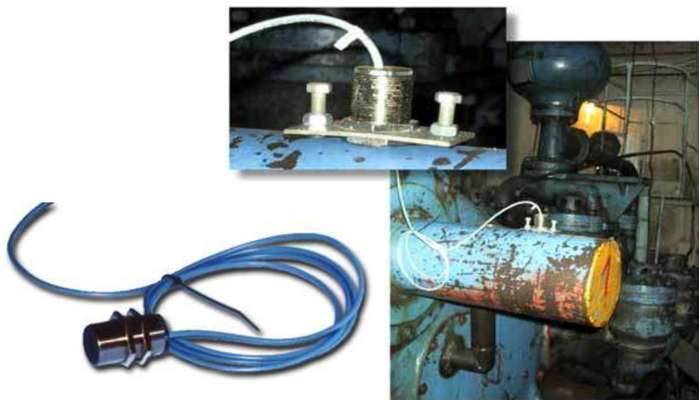
Рис. 5.76. Датчики ходов поршней буровых насосов и оборотов ротора
