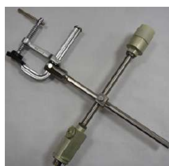
Рис. 5.66. Датчик ходов насоса
