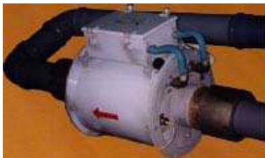
Рис. 5.94. Датчик расхода на входе
