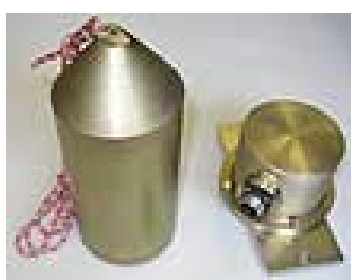
Рис. 5.63. Датчик плотности ПЖ в приемной емкости
