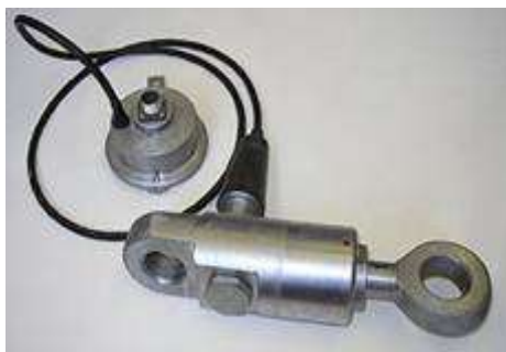
Рис. 5.41. Датчик момента на ключе
