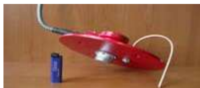
Рис. 5.93. Датчик суммарного газосодержания
