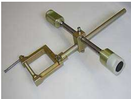
Рис. 5.45. Датчик оборотов ротора
