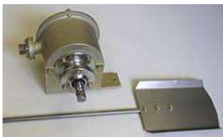
Рис. 5.47. Датчик потока (расхода) ПЖ на выходе
