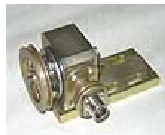
Рис. 5.61. Датчик оборотов вала буровой лебедки (датчик глубины)
