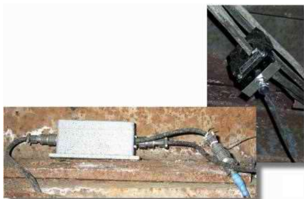
Рис. 5.79. Датчик момента на роторе с электрическим приводом
