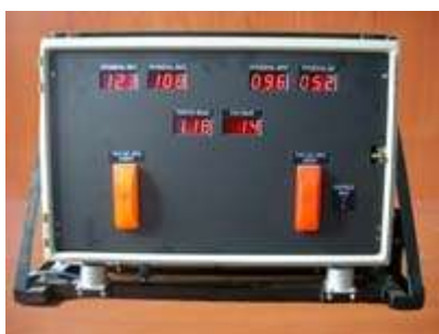
Рис. 5.95. Блок отображения плотности и уровня в емкостях, газосодержания на выходе и во взрывоопасной зоне
