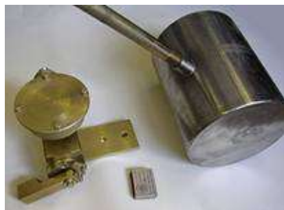
Рис. 5.50. Датчик уровня ПЖ в приемной емкости
