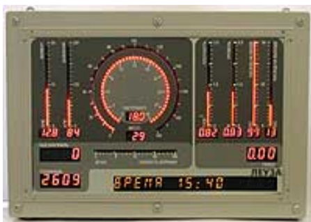
Рис. 5.67. Пульт бурильщика: количество контролируемых параметров: от 8; уровень входных сигналов, В: 0–5; 0–10; габариты, мм: 600 × 400 × 120; температура окружающей среды, °С: –45...+50
