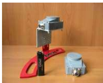
Рис. 5.87. Датчик оборотов ротора
