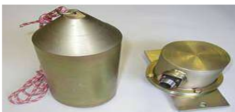
Рис. 5.46. Датчик плотности ПЖ в приемной емкости
