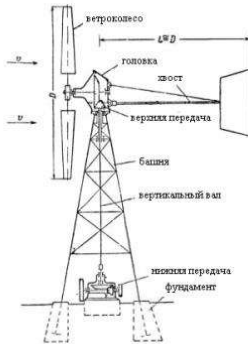
Рис. 11.2. Вітроелектрична установка і її основні елементи
