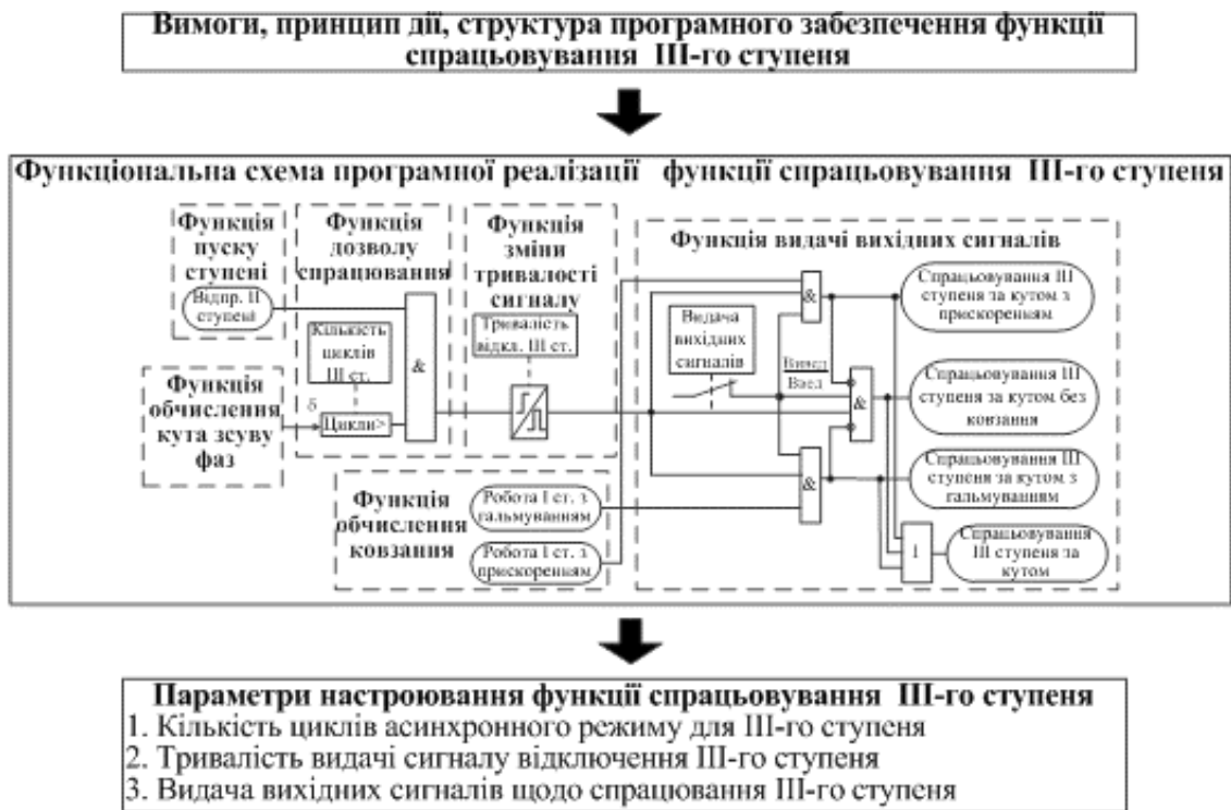
Рисунок 6.12 – Каузальний ланцюг знань з визначення функціональної схеми програмної реалізації та параметрів налаштування функції спрацювання III-го ступеня пристрою ліквідації асинхронного режиму
