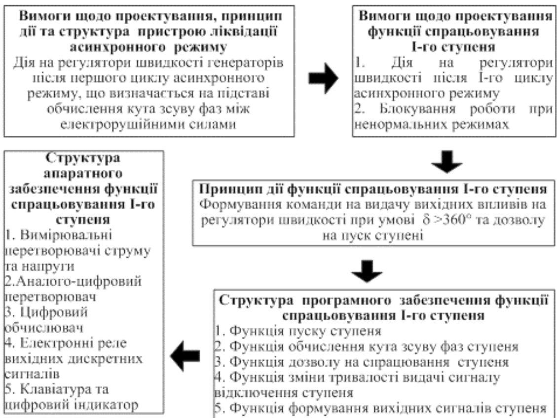
Рисунок 6.7 – Каузальний ланцюг знань з визначення вимог щодо проектування, принципу дії й структури програмного та апаратного забезпечення функцій спрацьовування I-го ступеня пристрою
