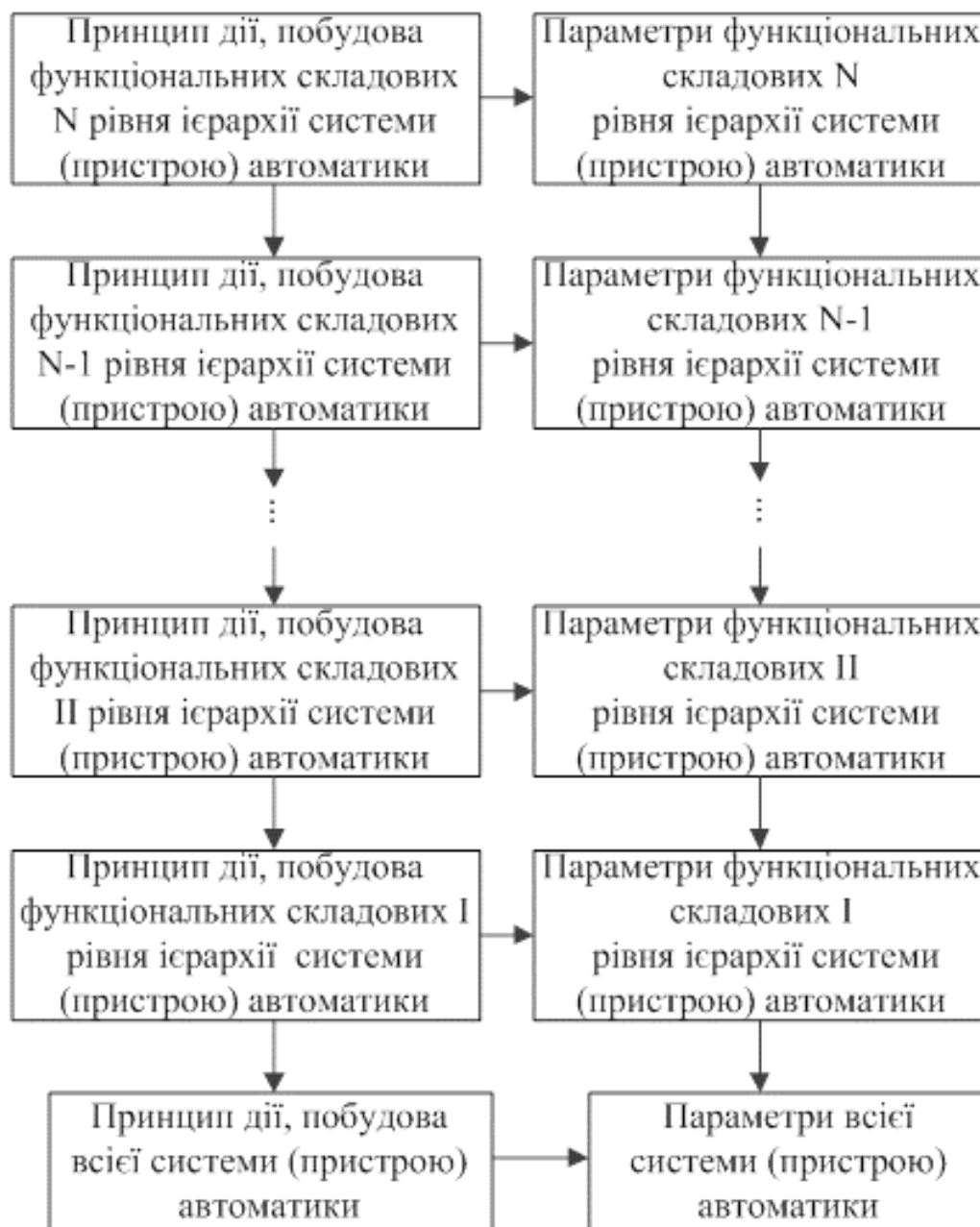
Рисунок 6.33 – Каузальний ланцюг знань при визначенні показників функціонування системи (пристрою) автоматики об'єкту (елементу) енергосистеми
