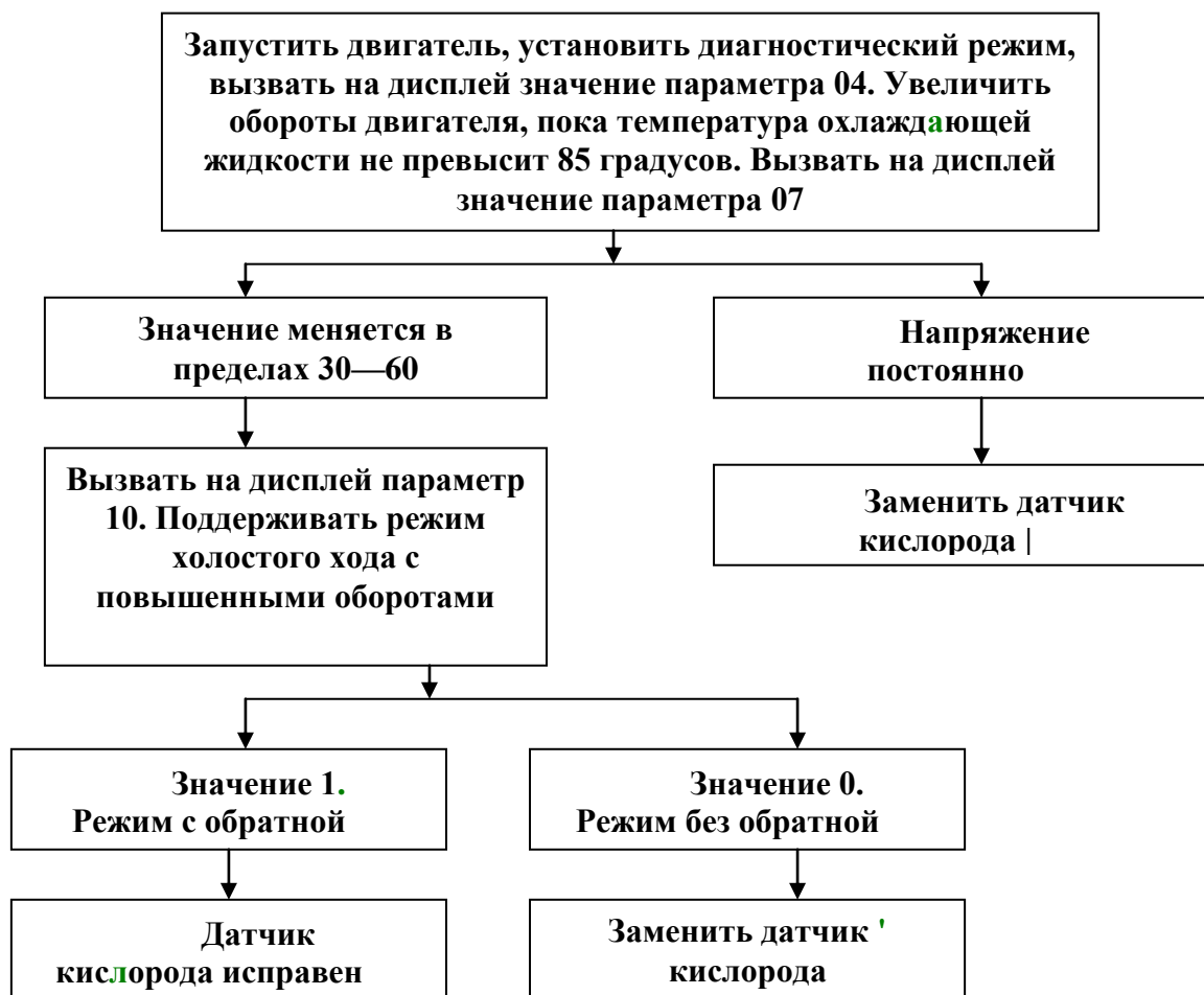
Рис. 5. Проверка работоспособности датчика кислорода
