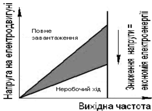
Рис. 4.18 Діаграма енергоощадного режиму електропривода
