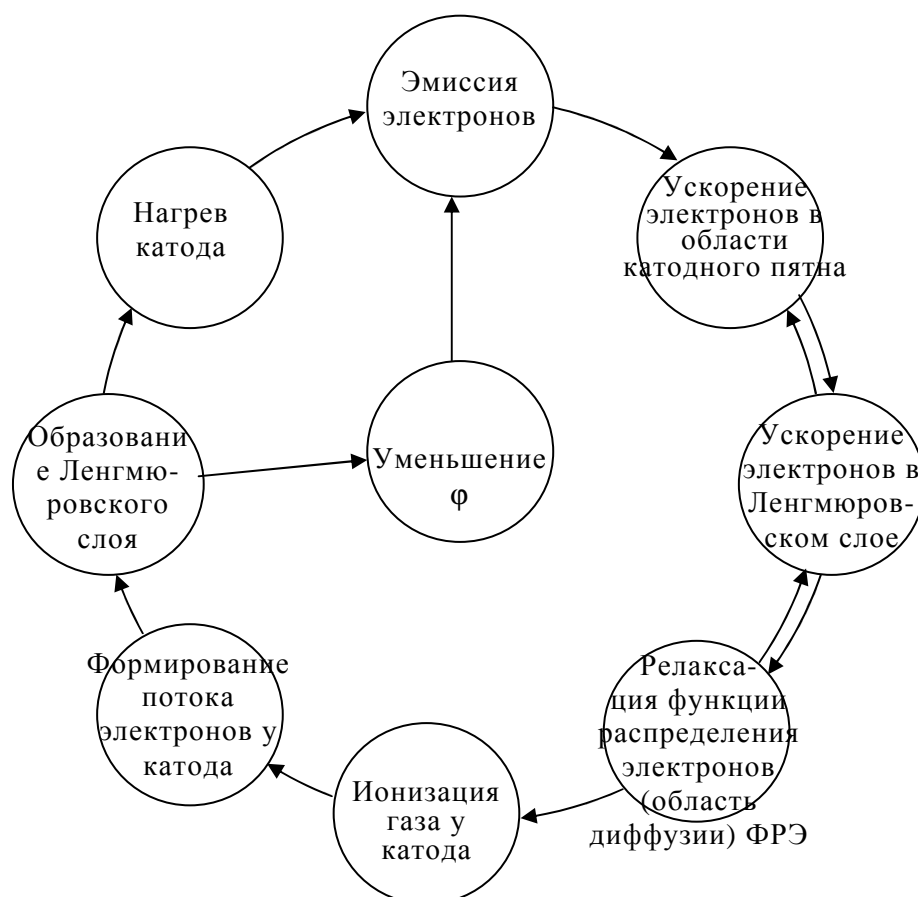
Рис. 3.10 - Схема модели катодных процессов в источниках света высокого давления [65]
