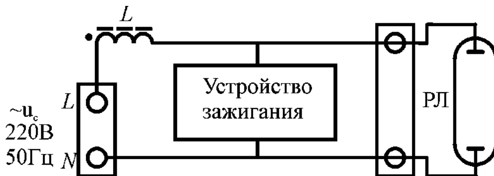
Рис. 3.2 - Схема электромагнитного ПРА
