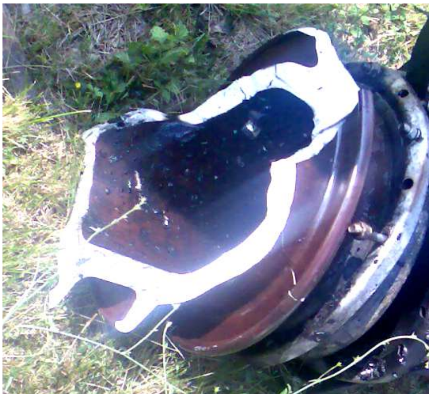
Рисунок 1.25 – Разрушение опорного изолятора в результате электродинамического воздействия
