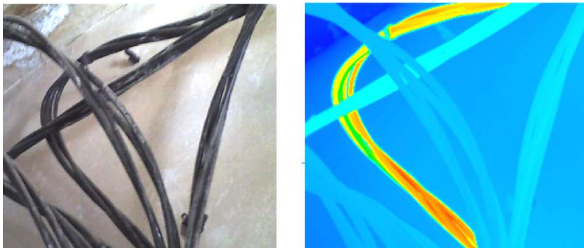
Рисунок 1.11 – Перегрев проводов пересекающихся изолированных линий внутренних проводок сети 0,4 кВ, зафиксированный тепловизором
