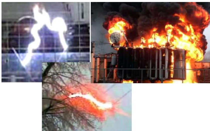
Рисунок 1.28 – Возникновение и последствия электрической дуги
