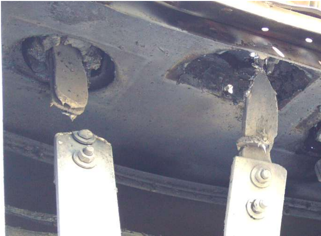
Рисунок 1.23 – Термические разрушения в результате КЗ на шинах
