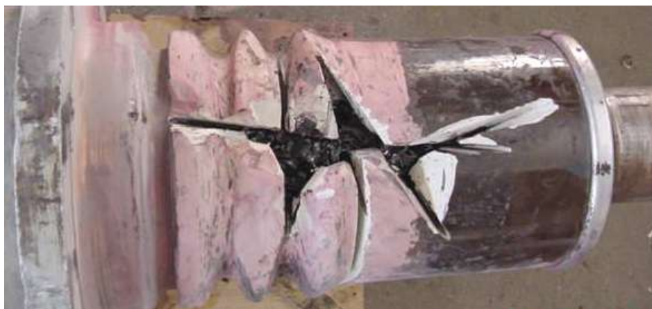
Рисунок 1.10 – Механическое разрушение длительно эксплуатируемого изолятора
