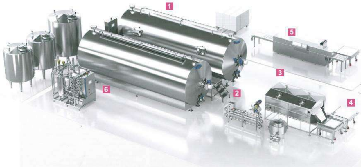
Рисунок 4 - Линия производства зернового творога (1-вертикальный творогоизготовитель, 2-трубчатый охладитель, 3-модуль частичного отделения сыворотки и заполнения форм, 4-тележка для творога, 5-автомат для упаковки, 6-CIP мойка)
